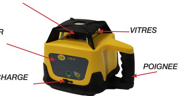
Lorsque l'instrument commencera à tourner, il émettra un rayon laser pour former un plan horizontal et une ligne d'aplomb automatique.
